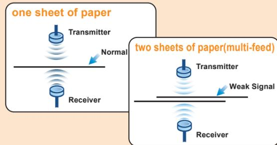
Der PS406U Plus kann mit seinem Ultraschall Sensor einen Mehrfach-Einzug von Dokumenten erkennen. In diesem Fall wird der Anwender von der Software entsprechend informiert.
