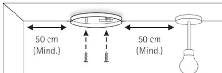
Der Rauchwarnmelder (im Folgenden RWM abgekürzt) sollte an der Decke und mindestens 50 cm von Wänden und Hindernissen entfernt montiert werden, idealerweise in der Raummitte.
