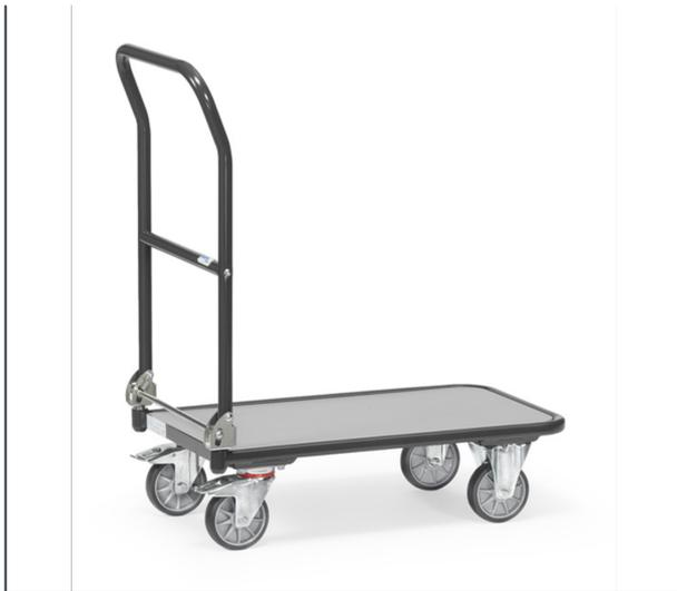
Klappwagen aus Stahlrohr, pulverbeschichtet anthrazitgrau RAL 7016. Ladefläche aus Holzwerkstoffplatte, Oberfläche mittelgrau. Schiebebügel auf Plattform klappbar. 2 Lenk- und 2 Bockrollen, TPE-Bereifung (spurlos), Naben mit Rillenkugellager. Feststeller an den Lenkrollen, gemäß der Europäischen Norm EN 1757-3 (Sicherheit von Plattformwagen).
