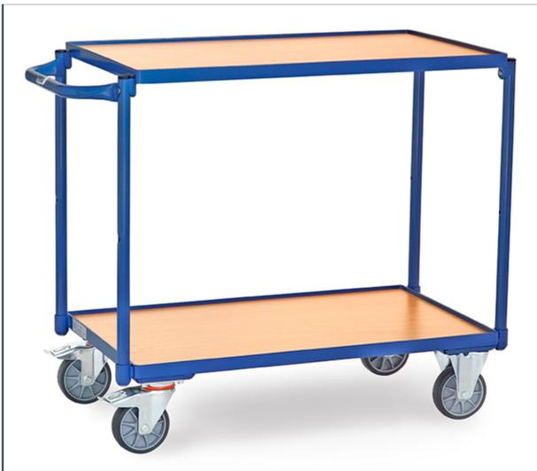
Leichter Tischwagen aus Stahlrohr und Profilstahl geschweißt, pulverbeschichtet brillantblau RAL 5007. Schraubkonstruktion. 2 Böden aus Holzwerkstoffplatte, Oberfläche Buchendekor, im Stahlrahmen liegend, Rand 12 mm hoch. Schiebegriff waagrecht. 2 Lenk- und 2 Bockrollen, TPE-Bereifung, Naben mit Rillenkugellager. Feststeller an den Lenkrollen, gemäß der Europäischen Norm EN 1757-3 (Sicherheit von Plattformwagen). Tragkraft obere Ladefläche 80 kg.
