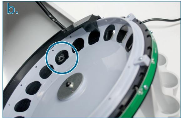
**Reinigen Sie ebenfalls die Drehplatte und die schwarze Leitplatte darunter, falls diese ebenfalls Verschmutzungen aufweisen**
