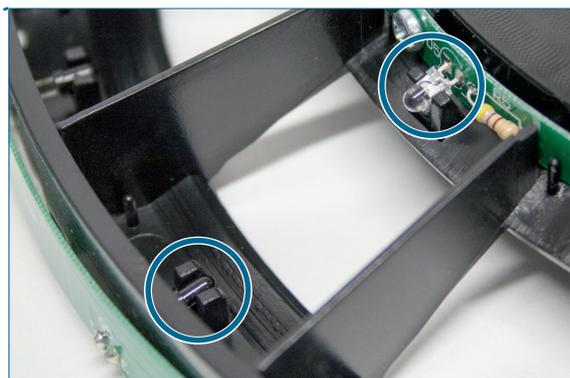
5. Reinigen Sie die Sensoren mit einem Wattestäbchen und Alkohol.
