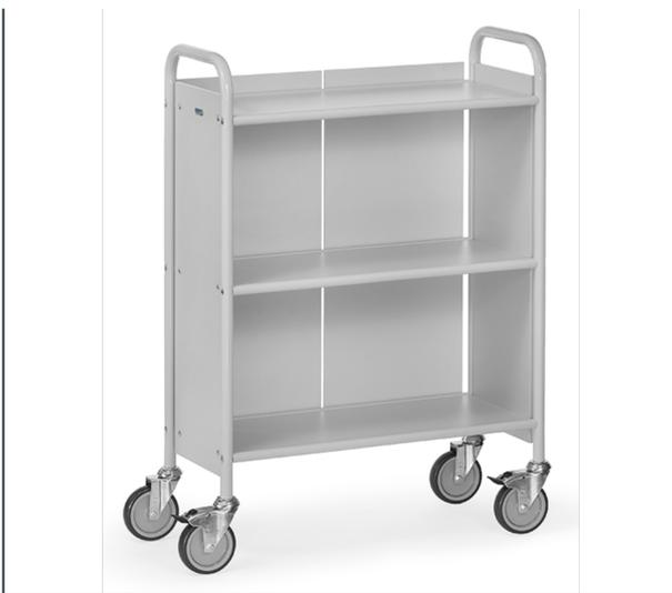
Baukasten-System: verschraubte Stahlrohr-Konstruktion, pulverbeschichtet in lichtgrau RAL 7035. Böden, Seitenwände und Längswand aus Holzwerkstoffplatten, hellgrau. 4 Lenkrollen, Räder mit TPE-Bereifung, elastisch und leicht laufend, spurlos. Naben mit Gleitlager. 2 Lenkrollen mit Feststeller, gemäß der Europäischen Norm EN 1757-3 (Sicherheit von Plattformwagen). Zerlegte Anlieferung, leichte Selbstmontage. Gesamtlänge: 810 mm, Gesamtbreite: 385 mm, Tragkraft pro Etage 50 kg.
