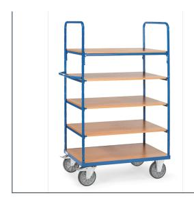
Baukasten-System: Aus Stahlrohr und Profilstahl geschweißt, pulverbeschichtet blau RAL 5007, Schraubkonstruktion. Stirnwände offen. 1 fester und 4 lose Einlegeböden aus Holzwerkstoffplatten, Oberfläche Buchendekor. Einlegeböden variabel einsetzbar, Teilung 100 mm. Tragkraft pro Einlegeboden 90 kg. 2 Lenk- und 2 Bockrollen, TPE-Bereifung, Naben mit Rillenkugellager. Feststeller an den Lenkrollen, gemäß der Europäischen Norm EN 1757-3 (Sicherheit von Plattformwagen).
