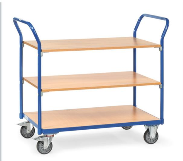
Profilstahl-/Stahlrohr-Schweißkonstruktion, pulverbeschichtet, brillantblau RAL 5007. 3 Böden aus Holzwerkstoffplatte, Oberfläche Buchendekor. 2 Lenk- und 2 Bockrollen, TPE-Bereifung, Naben mit Rillenkugellager. Feststeller an den Lenkrollen, gemäß der Europäischen Norm EN 1757-3 (Sicherheit von Plattformwagen). Tragkraft mittlere und obere Ladefläche 80 kg.
