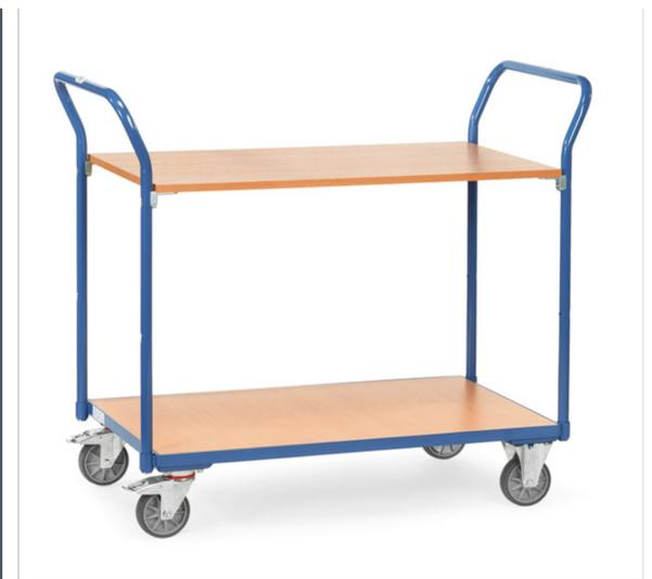
Tischwagen aus Profilstahl-/Stahlrohr-Schweißkonstruktion, pulverbeschichtet, brillantblau RAL 5007. 2 Böden aus Holzwerkstoffplatte, Oberfläche Buchendekor. 2 Lenk- und 2 Bockrollen, TPE-Bereifung, Naben mit Rillenkugellager. Feststeller an den Lenkrollen, gemäß der Europäischen Norm EN 1757-3 (Sicherheit von Plattformwagen).
