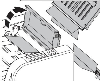
**DE** Bei Bedarf beide Falztaschen abnehmen und die Rollenabdeckung öffnen. Papier restlos entfernen.
