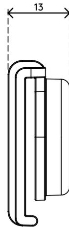
**Addit Kabelführung – Magnetbefestigung 483**
