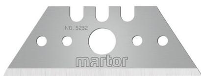
Die TRAPEZKLINGE NR. 5232 von MARTOR ist eine hochwertige Klinge aus Stahl. Sie ist sehr scharf und verfügt über zwei nacheinander nutzbare Schneidkanten für eine höhere Einsatzzeit. Der Breitschliff erleichtert das Schneiden. Die Klinge ist 53 mm lang, 19 mm breit und 0,63 mm stark.
