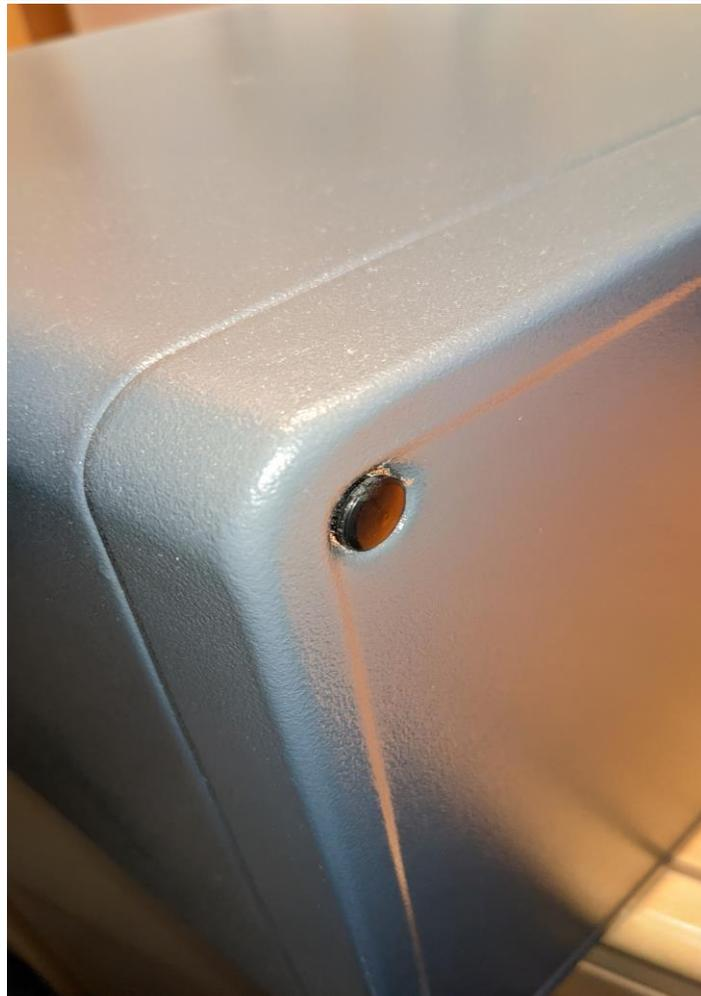
Das Loch in der Rückwand dient zur Aufhängung während des Lackierprozesses.
