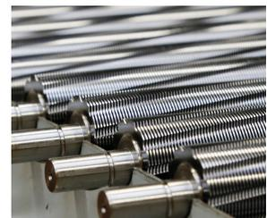
Die induktionsgehärteten Vollstahl-Schneidwellen sind unempfindlich gegen Heft- und Büroklammern und garantieren Langlebigkeit.
