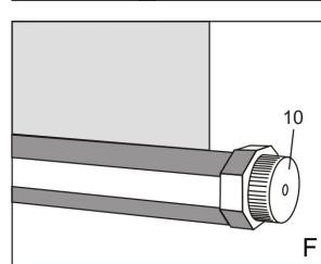
Durch Linksdrehen des Spannknopfes (10) können Sie die Bildwand gegebenenfalls nachspannen. Zum Spannen ist 1/2 Umdrehung erforderlich.
