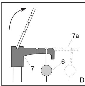
Ziehen Sie die Projektionsfläche (6) aus dem Tubus heraus und arretieren Sie diese in den Rillen des Haltebügels (7). Ziehen Sie das Innenrohr (3) in die gewünschte Position und stellen es mit dem Arretierhebel (5) fest.
