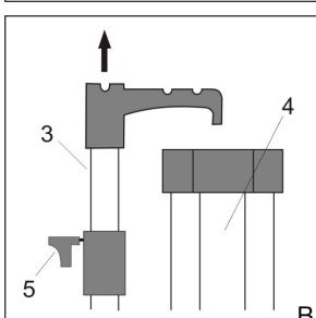
Arretierhebel (5) drücken und gleichzeitig das Innenrohr (3) ca. 10 cm nach oben ziehen.
