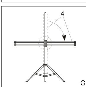
Stativleinwand (4) in die waagerechte Lage drehen.
