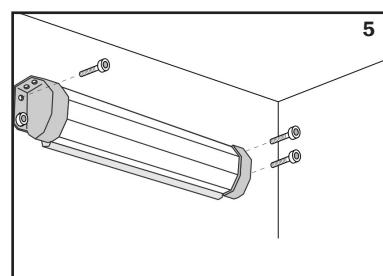
Um eine gute Planlage der Leinwand zu erreichen, ist es wichtig, dass das Gehäuse exakt waagerecht montiert wird. To ensure the screen is mounted straight and true, it is important that the housing is mounted exactly horizontally.
