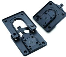
Bringen Sie Ihren HP Desktop Mini mit der HP Quick Release Halterung 2 an einem HP Display<sup>1</sup> und einer Vielzahl von Standfüßen, Armen oder Wandhalterungen an.<sup>2</sup> Der ausfallsichere „Sure-Lock“-Mechanismus verriegelt den PC sicher und lässt sich mit einer Sicherheitsschraube zur Diebstahlsicherung weiter befestigen.
