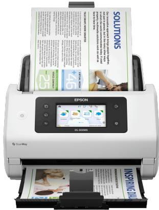
Der WorkForce DS-900WN ist ein netzwerkintegrierter Hochgeschwindigkeitsscanner mit Wi-Fi-Technologie und Kompatibilität mit Open Plattformen. Ausrichtungsplatte für Papier im Lieferumfang enthalten.
