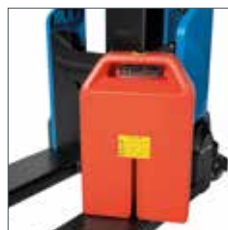
Optional: Wechselakku mit 20 Ah, 30 Ah oder 36 Ah
