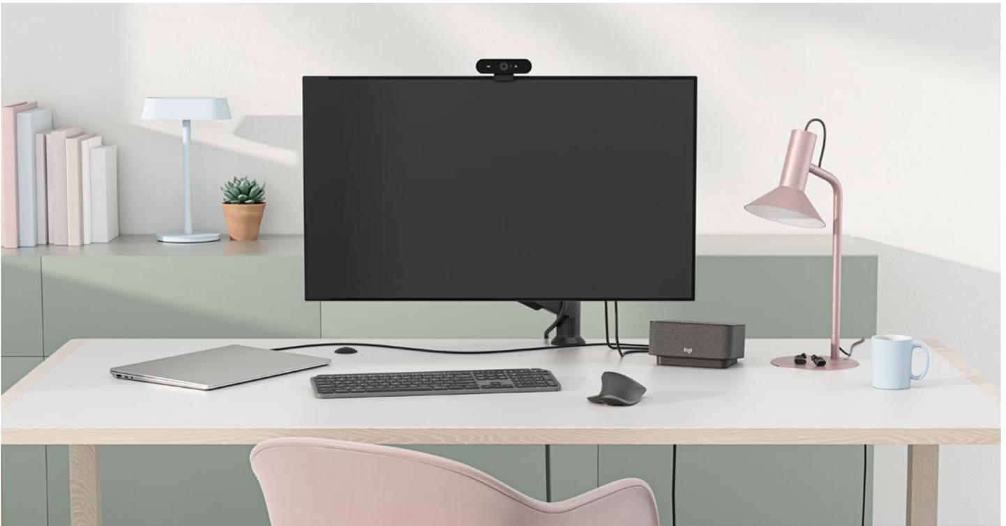
Logi Dock verbindet bis zu fünf USB-Peripheriegeräte und bis zu zwei Monitore<sup>1</sup>, während Ihr Notebook mit bis zu 100 Watt versorgt wird. Da weniger Kabel und Dongles benötigt werden, schafft Logi Dock Platz für einen aufgeräumten Schreibtisch und angenehmeres Arbeiten.
