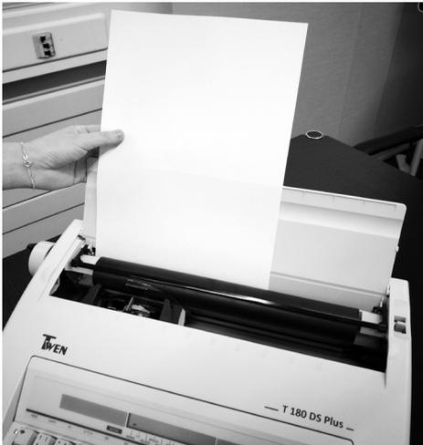
Drehen Sie den Walzendrehknopf, um das Papier einzuziehen. Wenn die obere Kante des Papiers unter der Papierwalze sichtbar wird, heben Sie den Papierhalter an. Ziehen Sie das Papier weiter ein, bis es sich zwischen Papierwalze und Papierhalter befindet.
